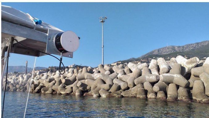
Figure 3 : Montage du lidar sur la cabine du Seaviews One .
