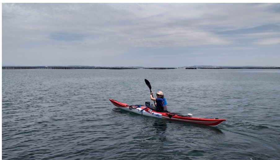
Figure 8 : Réalisation des levés au sondeur monofaisceau avec un kayak de mer.
